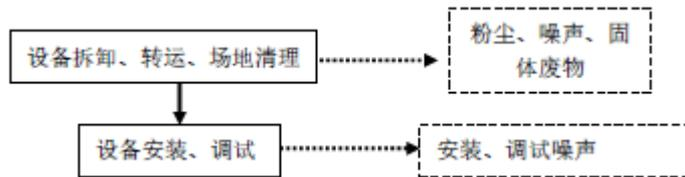
图 2-3 施工期工艺流程及产污图
